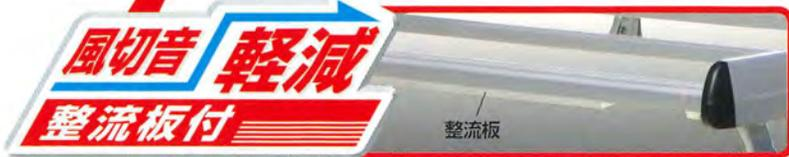
走行中に発生する耳障りな風切音を整流板によって軽減します。
